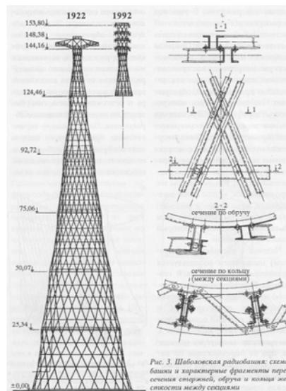
Рис. 3 Шаболовская радиобашня: схема башни и характерные фрагменты пересечения стержней, обречки и кольца жесткости между секциями
